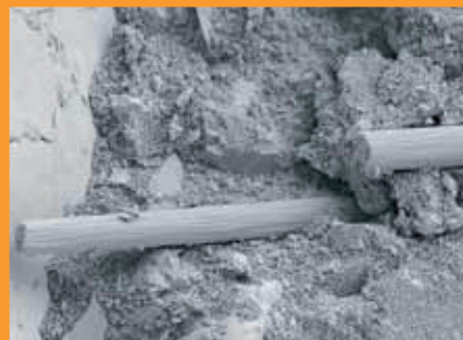
Vergroting: doorsnede van de nanokristallijne carbonvezels ingebed in CarboNit.
